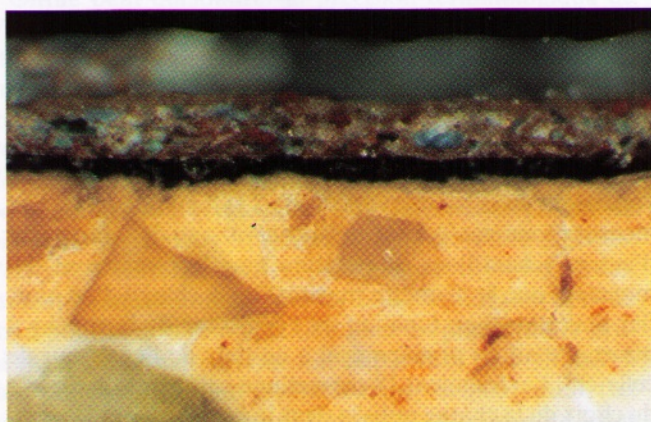
Fig. 11 Saint-Antoine, fragment 19, grain de raisin mauve sur fond noir appliqués sur une couche de tuileau, stratigraphie. Les surfaces de l' intonaco , imprégné de tuileau, et du fond noir ont été particulièrement bien lissées. Microscopie optique, gross. sur dia 24 x 36 mm: 65 fois.
