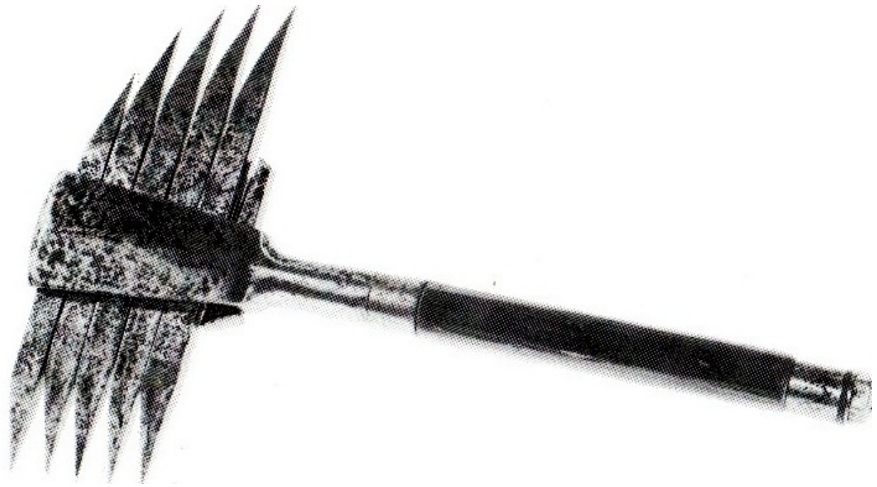
Martello 'a pettine', per pietre dure. Qui sotto, le tracce lasciate da questo strumento sulla pietra.
